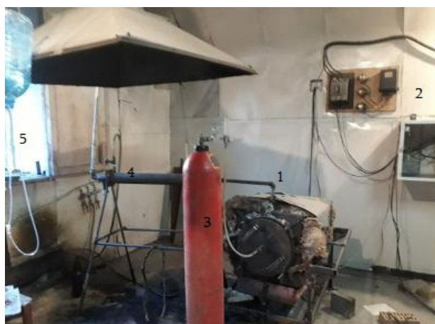
სურათი 1. ცელულოზაშემცველი მეორადი ნედლეულიდან მაღალი ხვედრითი ზედაპირის მქონე ნახშირბადოვანი მასალის მიღების ლაბორატორიული დანადგარი 1 - ღუმელი; 2 - მართვის ბლოკი; 3 - ინერტული აირის ბალონი; 4 - გაზური ფრაქციის დაყოფის სისტემა; 5 - წყლის მიწოდების სისტემა.
